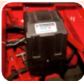
Centralina elettro idraulica
