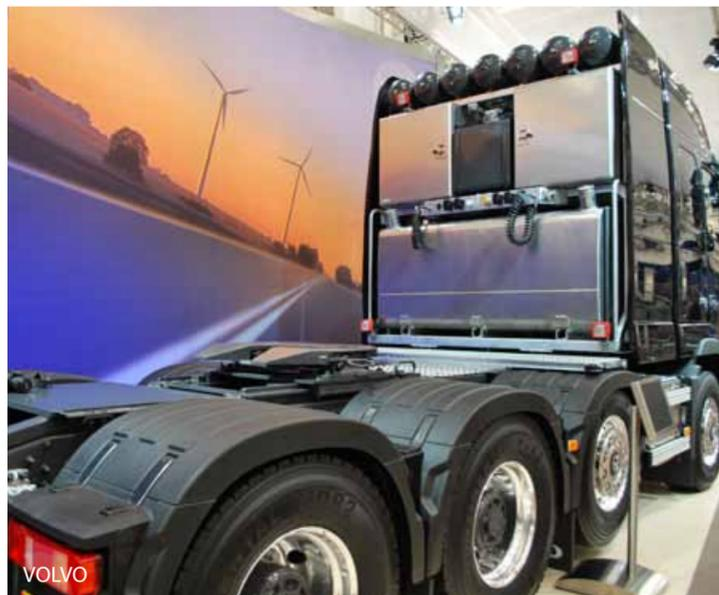
un Fh 16 da 700 Cv 8x4 per trasporto eccezionali, con un tridem posteriore che eleva il peso totale a 42,5 ton (9/7,5/13/13) con passo da 3.600 mm. Fra le motorizzazioni alternative spiccava quella a metano su un Fm con propulsore da 13 litri da 460 Cv
